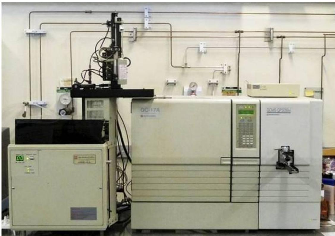
Figura 6 - Cromatógrafo a gás (GC 17A) acoplado à espectrômetro de massas (QP5050A)
