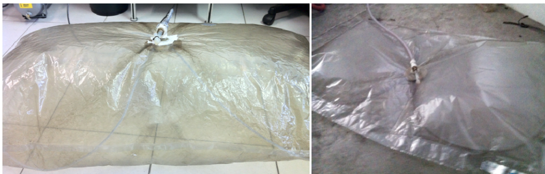
Figura 5 - Balão em Tedlar para armazenagem de gases de escapamento
