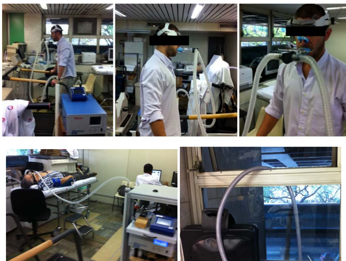
Figura 11 - Bocal adaptado com entrada do ar proveniente do sistema e saída para o meio externo
