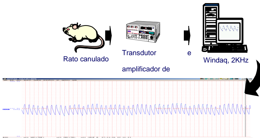
Figura 7- Esquema do sistema de registro de pressão arterial. (Desenho: S. Lacchini modificado).
