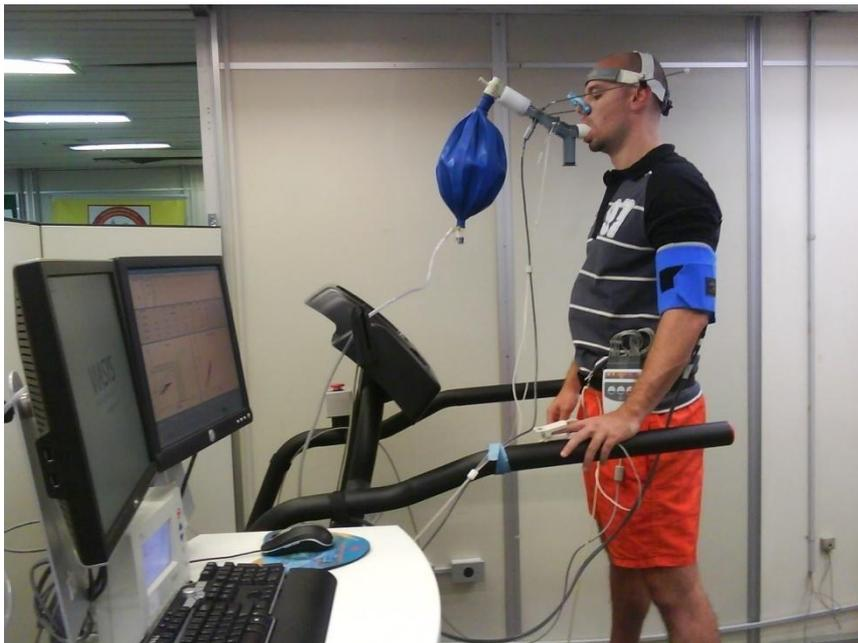
**Figura 2.** Sistema de entrega dos gases por *bag* conectado a cilindro contendo a mistura de gases necessária para a realização de cada teste (trocado a cada teste – não aparece na figura) com válvula unidirecional exalatória, sistema de válvula *pop-up*, clip nasal e sistema de análise de gases respiração a respiração.
