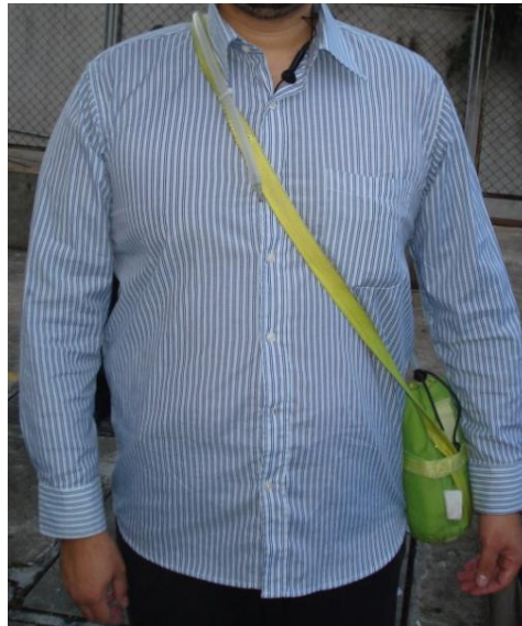
Figura 7. Equipamento pessoal para medição dos níveis diários de material particulado ( MP_{2,5} ).
