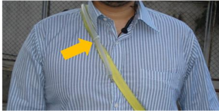
Figura 8. Detalhe da mangueira acoplada ao coletor do equipamento pessoal para medição dos níveis diários de material particulado ( MP_{2,5} ).
