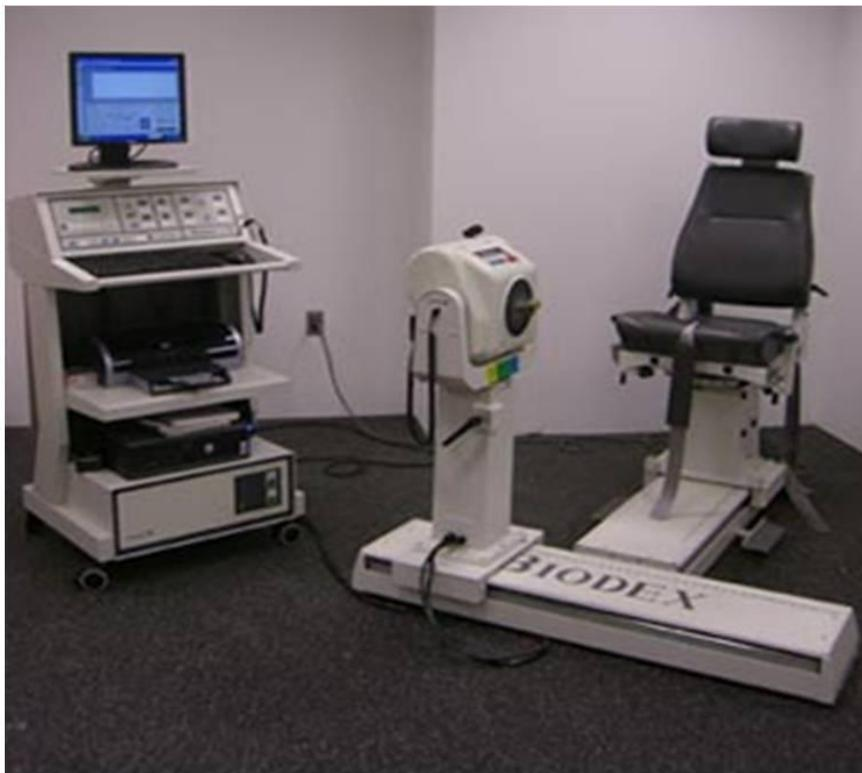
Figura 2. Dinamômetro isocinético – *Biodex System 3-pro*®.
