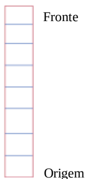
Figura nº 01 - Parte da placa cromatográfica, previamente cortada 8 x 1 cm e o seu comprimento delimitado em 8 pedaços de 1 cm cada.
