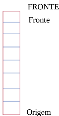
Figura nº 01 - Parte da placa cromatográfica, previamente cortada 8 x 1 cm e o seu comprimento delimitado em 8 pedaços de 1 cm cada.
