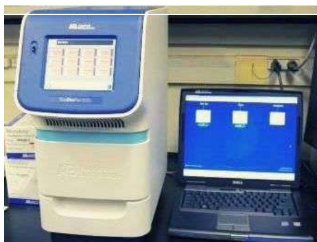
Figura 02 - StepOne Plus Real Time PCR Systems e computador acoplado
