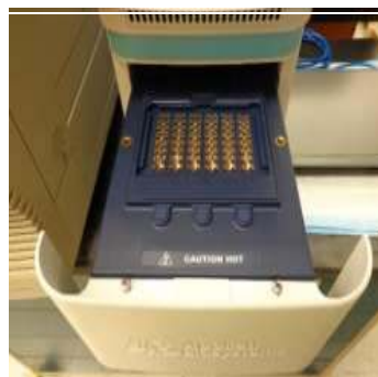
Figura 03 - Gaveta aberta para receber a placa de 96 poços com a reação/PCR
