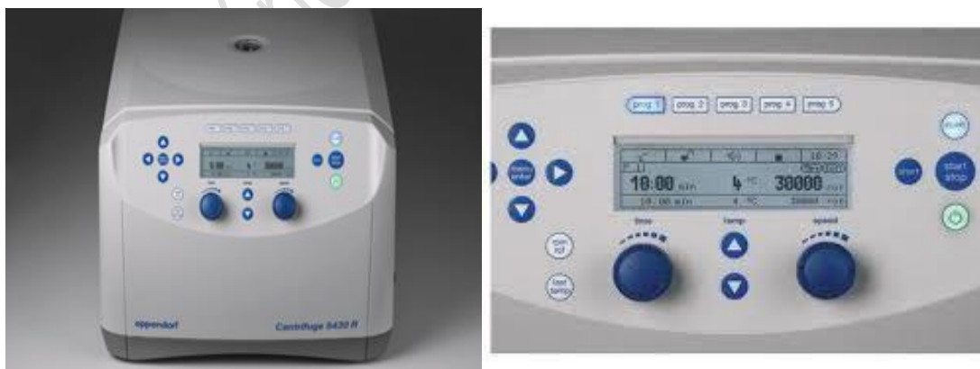
Figura 1. Layout do painel de controle da Centrífuga 5430 R . Botão da esquerda, “time” seleção do tempo de centrifugação. Botão da direita, “speed” seleção da velocidade de rotação (máximo de 14.000 r.p.m.). Setas
