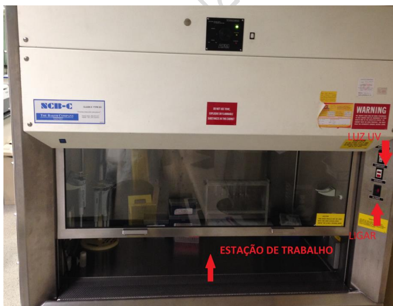
Figura 1. Layout do Fluxo Laminar e identificações.
