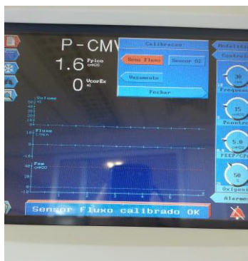
Figura 10: Ajuste para calibração do sensor de fluxo
