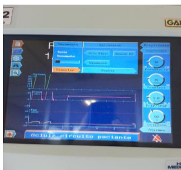
Figura 9: Ajuste para calibração de vazamento
