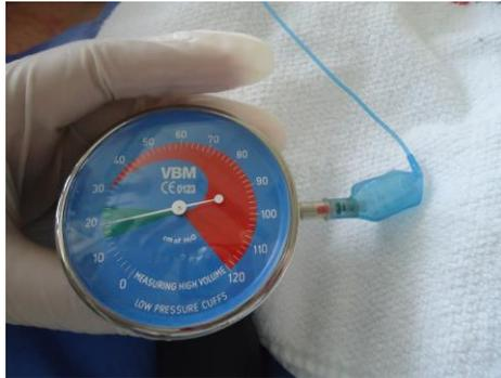
Figura 8: Manômetro para medir pressão de cuff
