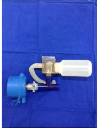
**Figura 6:** Manovacuômetro e válvula unidirecional conectados ao tubo T
