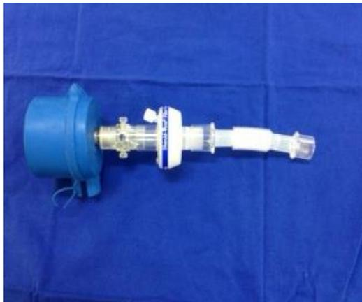
**Figura 5:** Manovacuômetro conectado ao Trocador de Calor e Filtro
