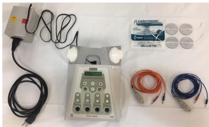
Figura 1: Aparelho Endophasys para estimulação elétrica, eletrodos e cabeamento
