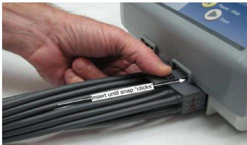
**Figura 8:** Conexão do conjunto de mangueiras
