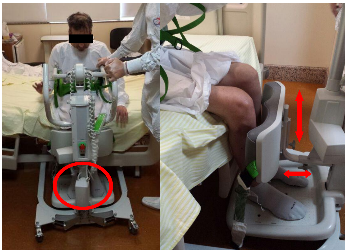
Figura 6: Posicionamento dos Pés do Paciente na Base de Apoio e do Apoio de Pernas
