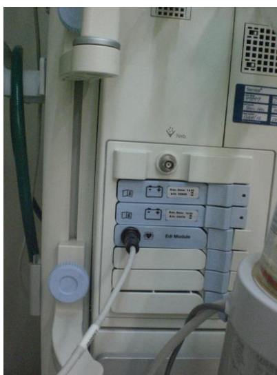
Figura 3: Cabo Aedi instalado no módulo
