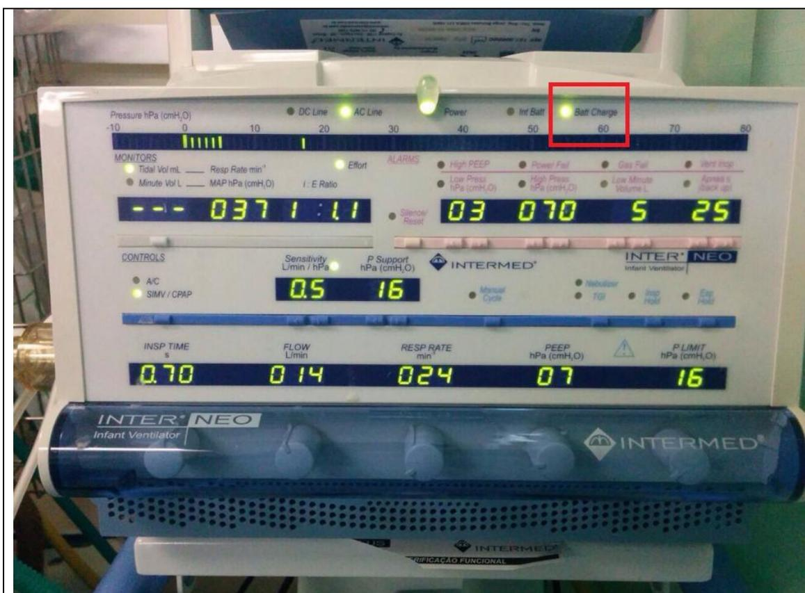
Figura 40: Carga da bateria
