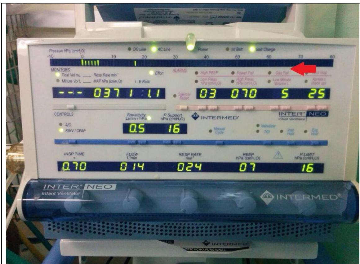
Figura 34: Falha de gás
