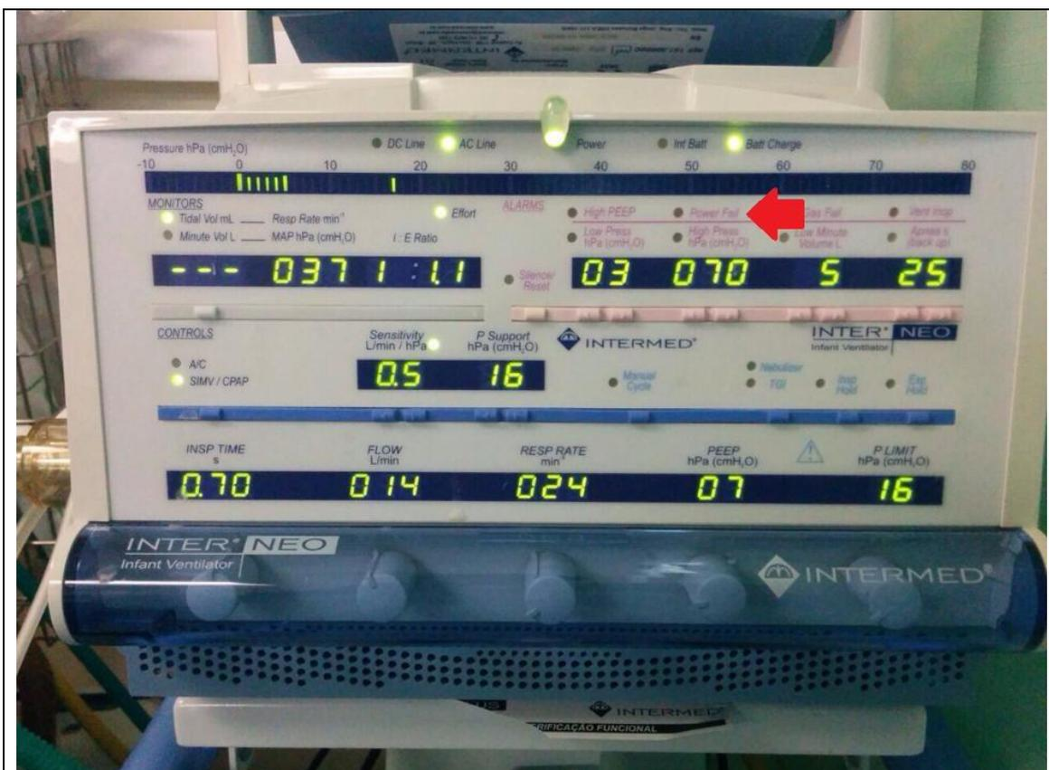
Figura 35: Falha de energia
