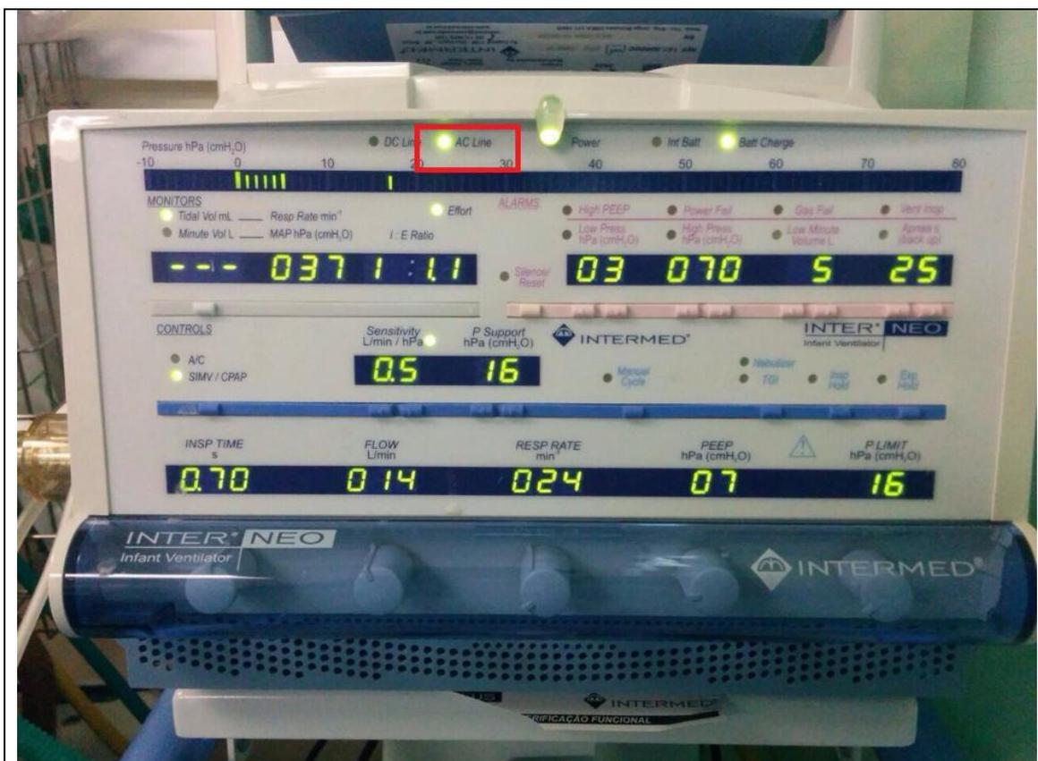
Figura 37: Corrente Alternada (AC LINE)
