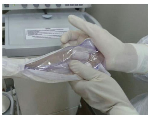
Teste de fuga no circuito
