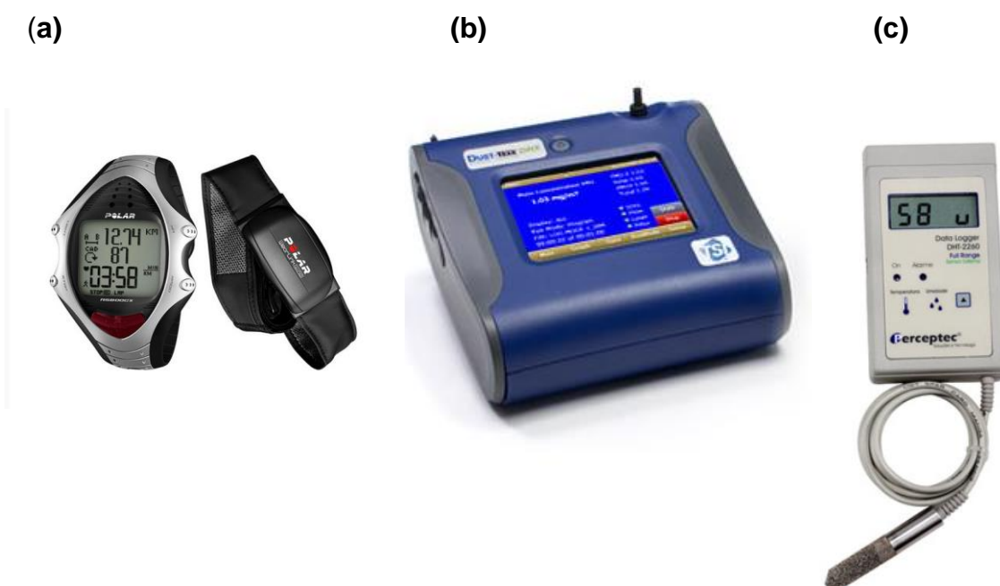
Figura 7. (a) Freqüencímetro cardíaco portátil (Polar RS800); (b) Espectrofotômetro de massa portátil DustTrak Aerosol Monitor (Modelo 8533 TSI); (c) Termo-higrômetro Data Logger DHT (Modelo 2260 Full Range - Perceptec).
