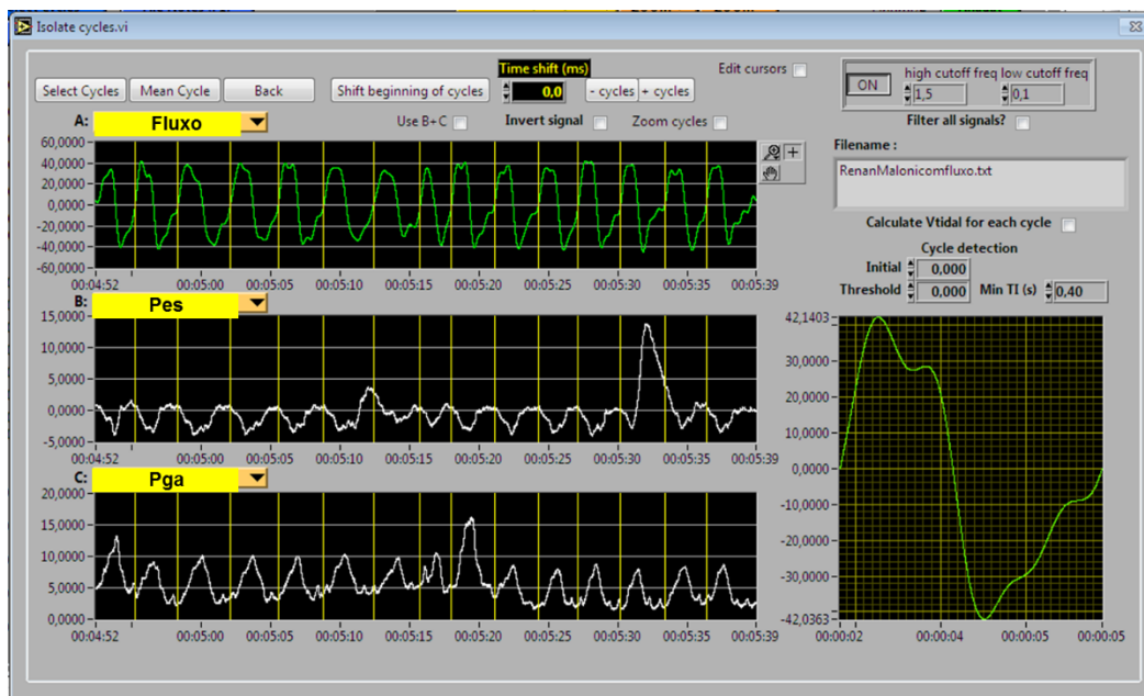
Figura 20 - início do ciclo detectado a partir do sinal do fluxo. Na segunda linha está o sinal da Pes (com deflexões negativas) e na última linha o sinal da Pga (com deflexões positivas durante a inspiração). Nota-se uma deflexão positiva da Pes por volta do tempo 5:30. Trata-se de um ciclo com artefato que foi descartado.
