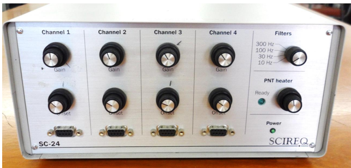
Figura 4.12 - Módulo de sinais (SC-24, SCIREQ, Canadá).
