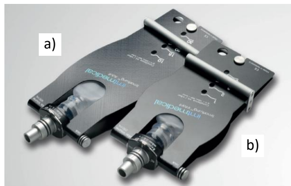
Figura 3.1 - Simuladores de pulmão SmartLung. a) SmartLung adulto. b) SmartLung infantil.
