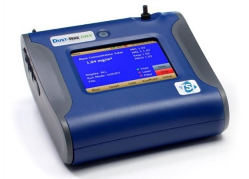
Figura 12 - Monitor de massa de aerossóis por espectrofotometria, MP DUSTTRAK Aerosol Monitor (Modelo 8520, TSI Inc., Mn, EUA).
