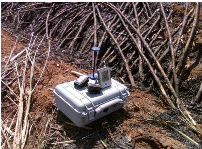
Figura 2- Monitor de material particulado  $MP_{2,5}$  (DustTrak) e Termohigrômetro
