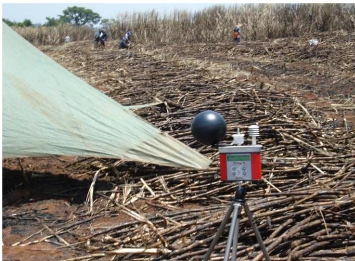
Figura 3- Medidor de Stress Térmico
