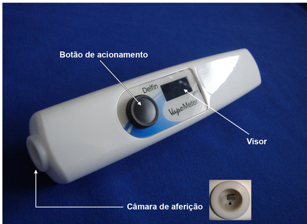
Figura 5 – “VapoMeter”: aparelho utilizado para mensurar o suor
