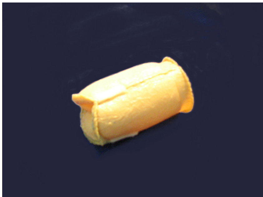
Figura 12. Um dos CVAPs avaliados no estudo hidrodinâmico foi mantido por 60 dias funcionando no DAV-Incor. Após a sua retirada observamos o aspecto abaulado na região dos seios de valsalva.
